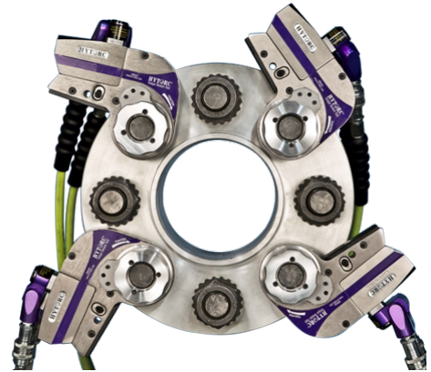
FLENSER: På flenser skal det kryss-strekkes. Her er fire verktøy montert i kryss, det vil si at man trekker til firebolter samtidig. Dette gir et bedre resultat samtidig som det går mye raskere. Foto: Hytorc
